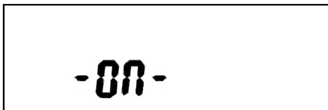
Рисунок 25 - Пример индикации готовности к работе оптопорта
