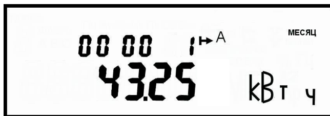
Рисунок 11 - Пример индикации значения суммарного потребления активной энергии по всем тарифам на РДЧ. В поле «Дата/Время» индицируется РДЧ
