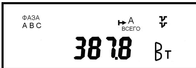
Рисунок 12 - Пример индикации значения суммарной активной мощности
