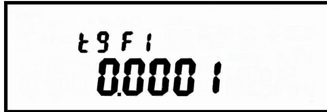
Рисунок 21 - Пример индикации суммарного значения коэффициента реактивной мощности цепи \text{tg } \varphi
