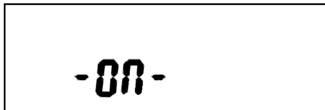
Рисунок 25 - Пример индикации готовности к работе оптопорта
