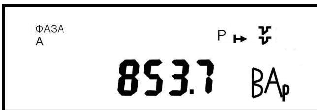
Рисунок 13 - Пример индикации значения индуктивной реактивной мощности по фазе А
