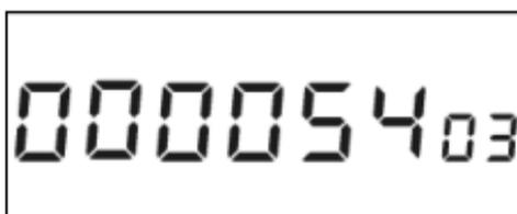
Рисунок Д.4 – Пример индикации заводского номера ДИЭ (зав.№ 5403), записанного в ДД
