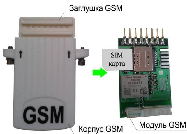
Рисунок 13 – Подготовка GSM-модема
