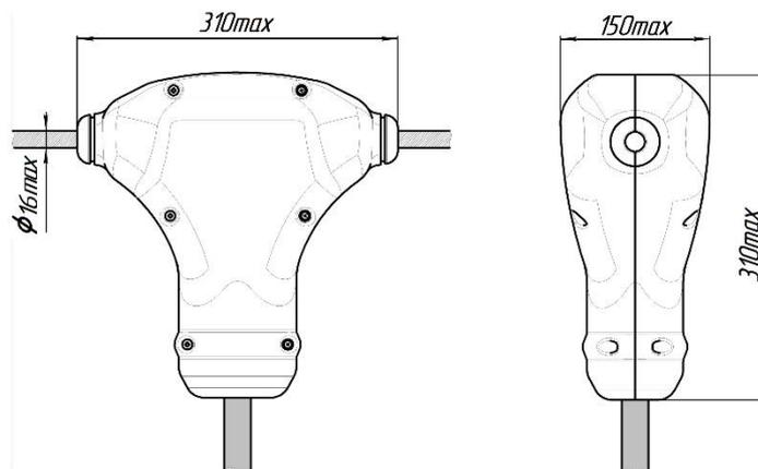
Рисунок А.2 – Габаритные и установочные размеры ДИЭ
