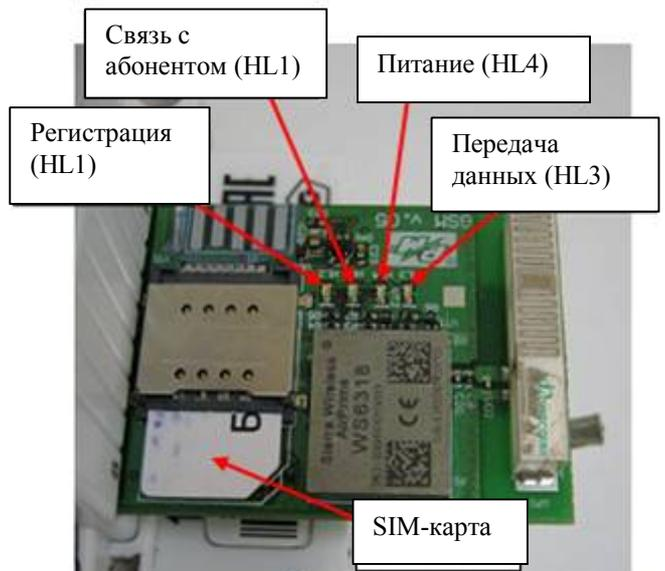
Рисунок В. 5 – GSM-модем (версия 1)
