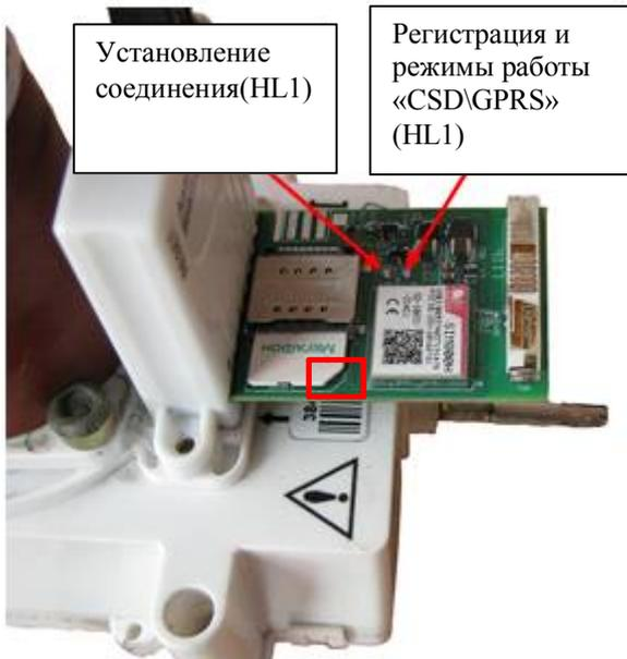
Рисунок В.4 – GSM-модем (версия 2)
