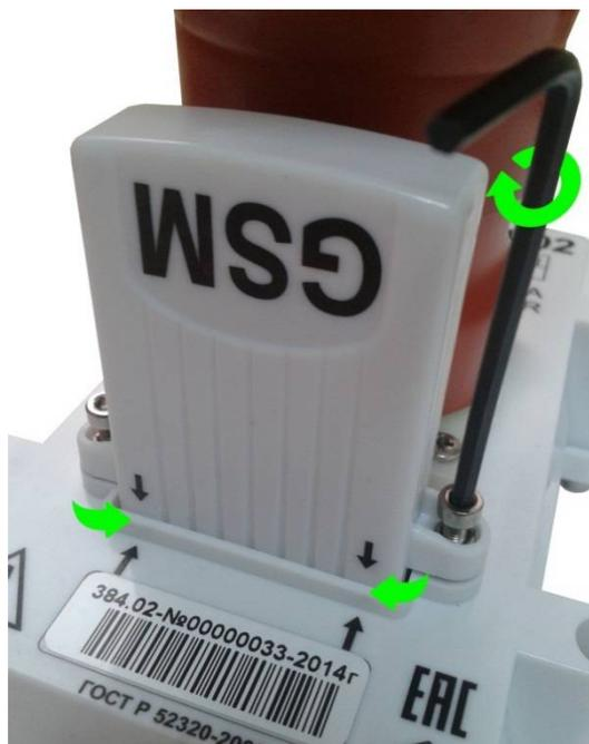
Рисунок 16 – Установка GSM-модема
