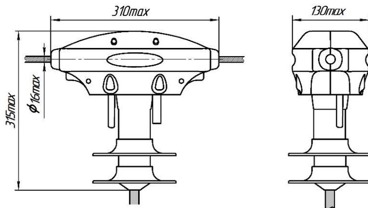
С корпусом внешним тип II (блок защитный не показан)
