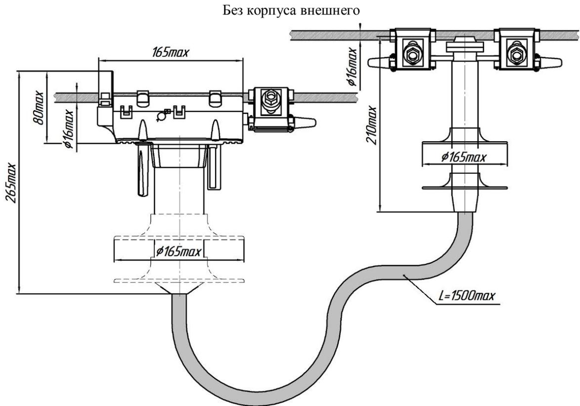
С корпусом внешним тип I (блок защитный не показан)
