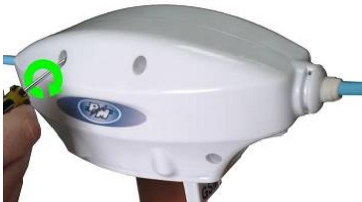
Рисунок 23 – Фиксация внешнего корпуса
