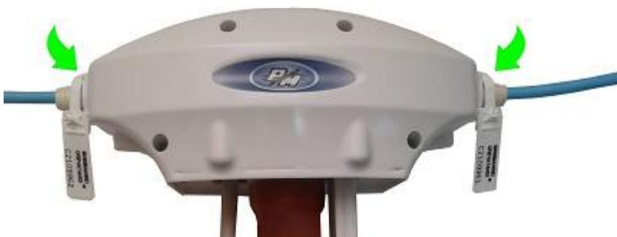
Рисунок 24 – Установка пломб
