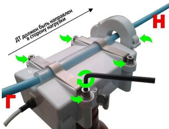
Схемы возможных вариантов подключения ИПУЭ см. на рисунке А.1 в приложении А. ДТ должен быть направлен в сторону нагрузки (см. рисунки 19). ДИЭ фиксировать на проводе ВЛ закрутив винты (4 шт.) ключом для внутреннего шестигранника S4. Втулка центрирующая, установленная на провод в месте крепления ДИЭ, должна быть зажата обеими скобами. После фиксации ДИЭ на ВЛ, зафиксировать (защелкнуть) ДТ.
