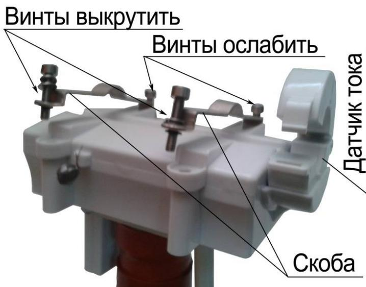
Для установки ДИЭ на провод ВЛ необходимо выкрутить два винта ключом для внутреннего шестигранника S4. Винты выкручивать со стороны размыкания ДТ (размыкание и фиксация ДТ происходит с помощью защелки). С противоположной стороны винты ослабить до такой степени, чтобы это позволило, подняв скобы (не изгибая), установить ДИЭ на провод ВЛ.
