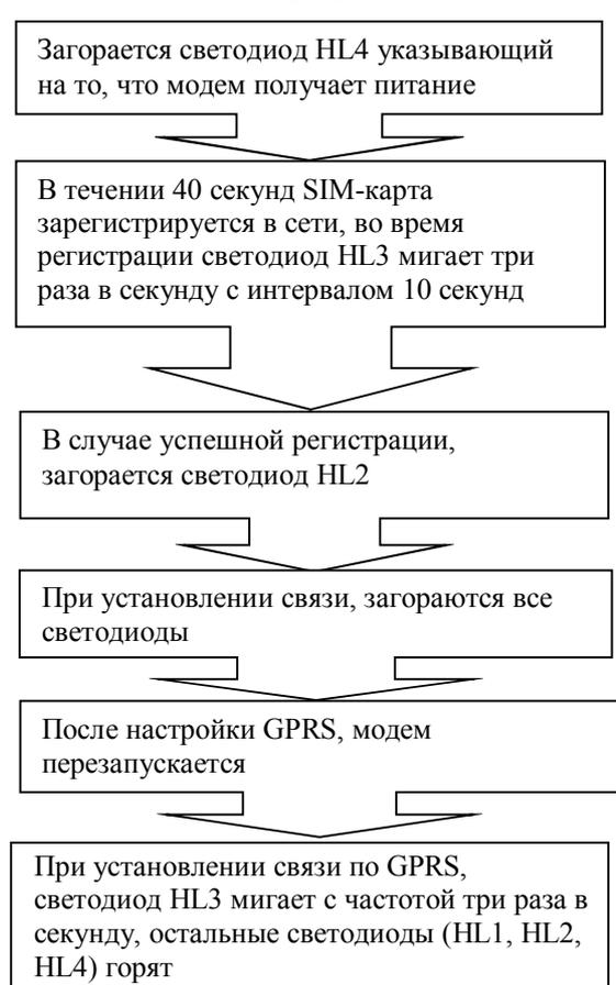
Схема В.1 – Индикация GSM-модемов
