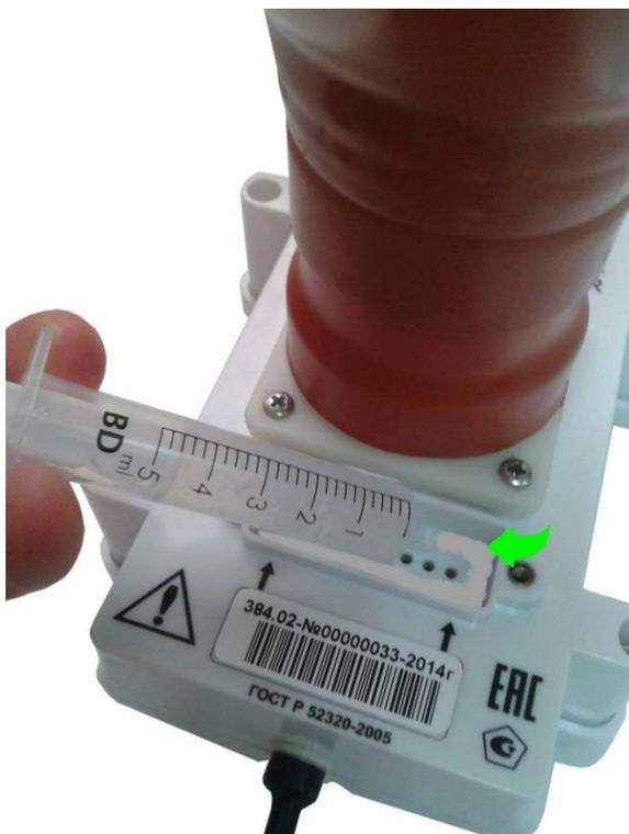
Перед подключением GSM-модема к ДИЭ, по всей площади, внутри места его установки, нанести слой смазки силиконовой толщиной 1-2 мм.
