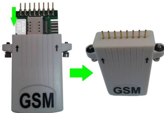
Установить GSM-модем в корпус и надеть заглушку.
