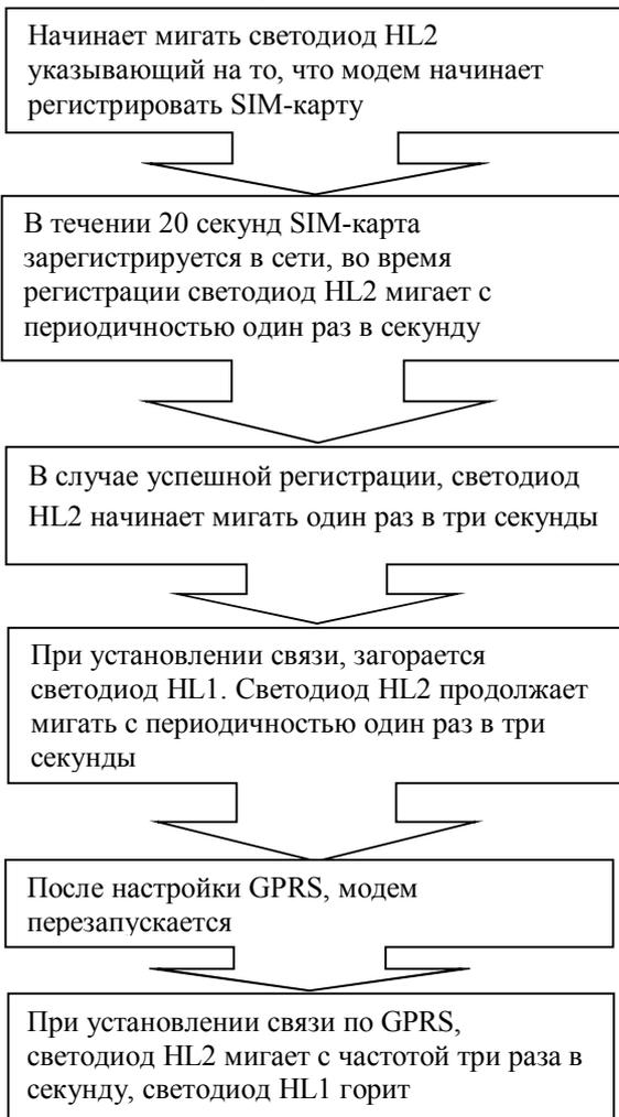
GSM – модем (версия 1) (GSM v.02 и т.п.)
