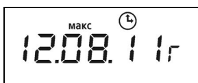
Рисунок 31 – Пример индикации даты фиксации максимальной активной мощности за последний закончившийся расчетный период (на РДЧ)
